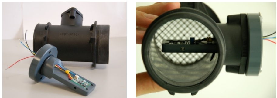
Εικόνα 1: Αισθητήρας ροής αερίου τοποθετημένος σε τυπωμένο κύκλωμα με τα κατάλληλα ηλεκτρονικά και εφαρμοσμένος στην κατάλληλα σχεδιασμένη βάση. Η βάση αυτή προσαρμόζεται σε σωλήνα εισόδου μηχανής αυτοκινήτου (μεγάλος μαύρος σωλήνας στις φωτογραφίες)
